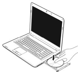
4. Legen Sie die Disc mit der Beschriftung nach oben auf die Lade und drücken sie vorsichtig hinunter. Die Disc liegt nun flach auf der Lade auf und rastet hörbar auf der Disc-Halterung ein.
