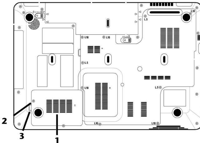
2. Entfernen Sie die Festplattenabdeckung (1) des Festplattenschachts, indem Sie die Schraube (2) lösen und die Festplattenabdeckung mit einem Schraubenzieher anheben (3) und abnehmen.
