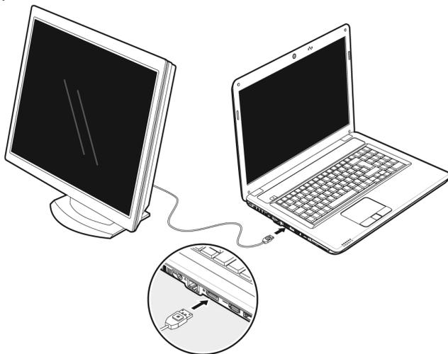
Alternativ können Sie den digitalen HDMI-Anschluss (High Definiton Multimedia Interface) (15) zur Übertragung von Bild- und Tonsignalen benutzen.
