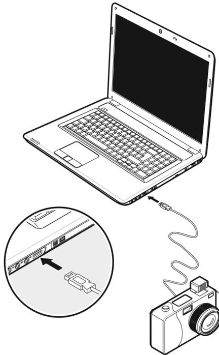
Die Datentransferrate liegt unter USB 1.1 bei 1,5 Mbit/s oder 12 Mbit/s, abhängig von dem daran angeschlossenen Gerät. USB 2.0 kann bis zu 480 Mbit/s erreichen.
